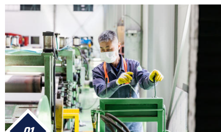
01 강판 코일 장착 코일 형태의 강판 장착
