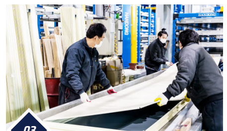
03 조립 및 삽입 핫프레스 위에 성형된 강판과 브림 또는 화스너를 놓고 조립·삽입
